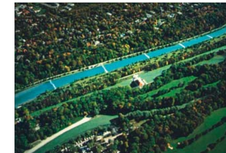
Die regelmäßige Abfolge von Sohlstufen, alle 200m eingebaut, damit sich der begradigte Fluss nicht in den Untergrund einräbt, behindert die Laichzüge der Fische und verwandelt die Isar bei Niedrig- und Mittelwasser in eine Kette aufgestauter Weiher.
