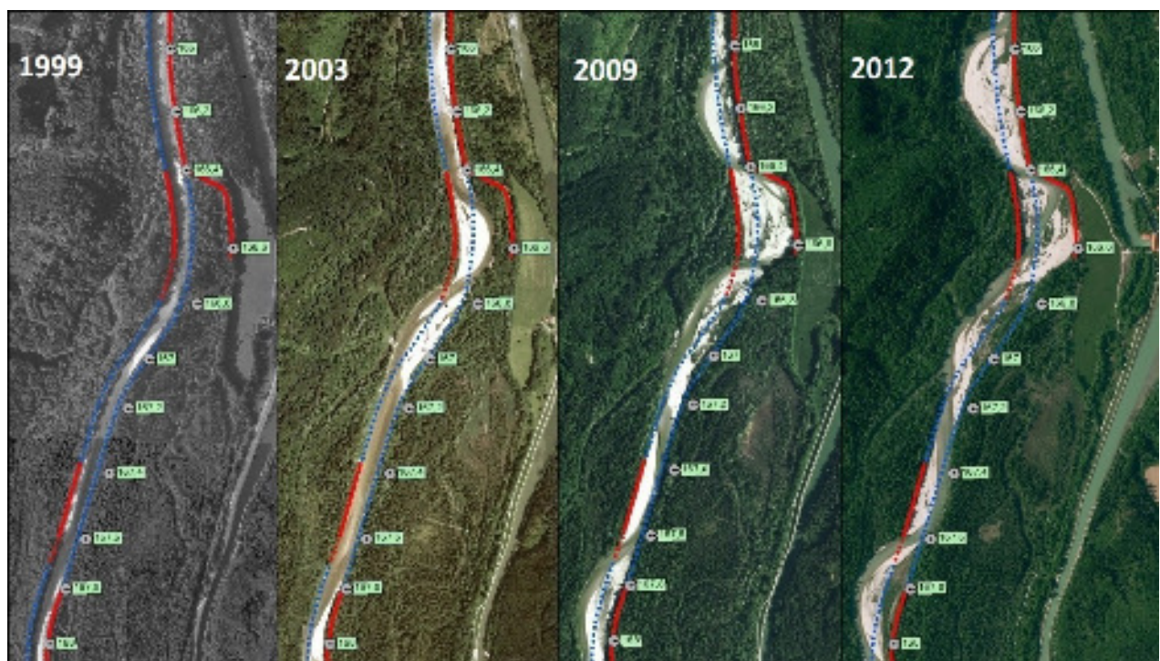
Abb. 4: Entwicklung der Isar seit 1999 zwischen Fkm 168 und 166 (Höhe Kraftwerk Mühlthal) - Orthofotos (Markierungen: blau = entnommene Uferversteinerung; rot = vorhandene Uferversteinerung; rot gepunktet = von der Isar mit der Zeit überspülte und z.T. abgetragene Uferversteinerung)
