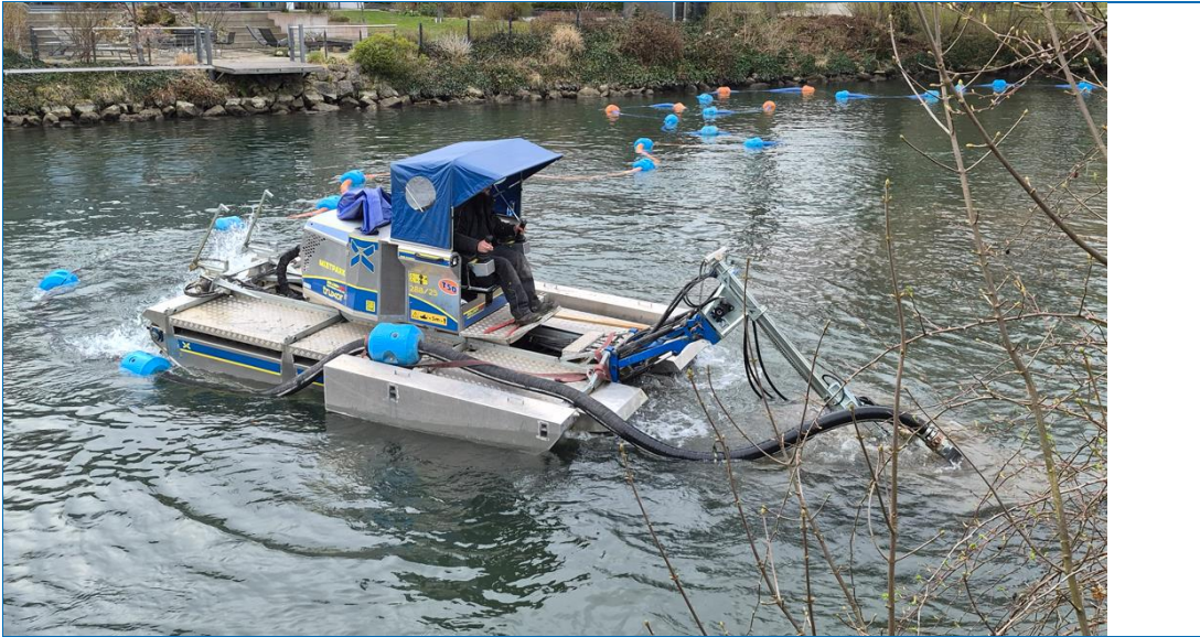
Abb. 1: Für die Entschlammung der Sempt kamen zwei spezielle Saugboote zum Einsatz.
